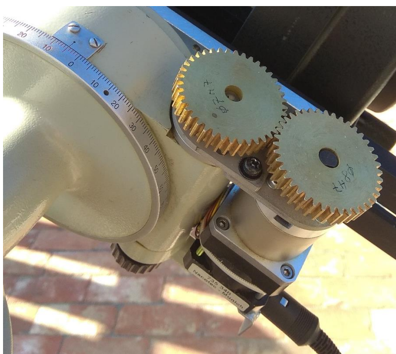
Der Antrieb für die Deklinationsachse
